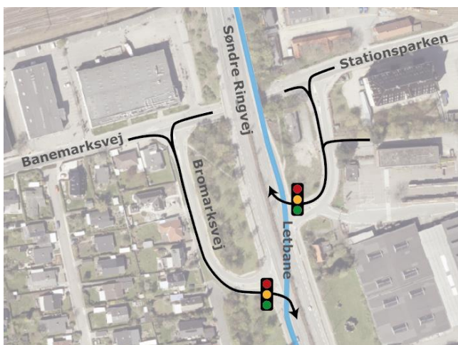
Figur 9. Signal ved krydsning af letbane ved tilkørsel til Søndre Ringvej.
